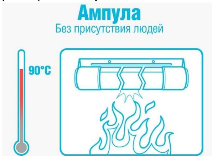
При возгорании, по мере возрастания температуры, в устройстве начинается ряд химических реакций, в результате которых внутри ампулы возрастает давление. Когда температура ОТВ достигает 90 °С, ампула разрушается и распыляет содержимое над очагом возгорания. При этом большая часть жидкости переходит в газообразную фазу. Огнетушащее вещество обладает комбинированным способом тушения. Производит активное охлаждение зоны горения, разбавляет горючую среду парами негорючего вещества, изолирует
